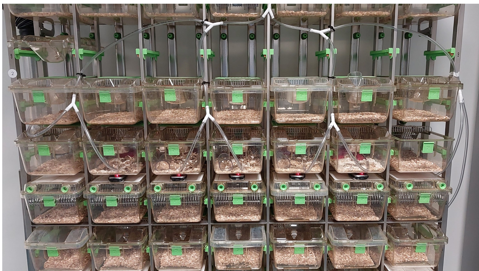
Figur 1: Opsætning af 5 IVC bure med varme og ilttilførsel. For at sikre kontakt mellem varmekude (Logilink) og IVC bur, skal buret nedenunder vendes omvendt.
