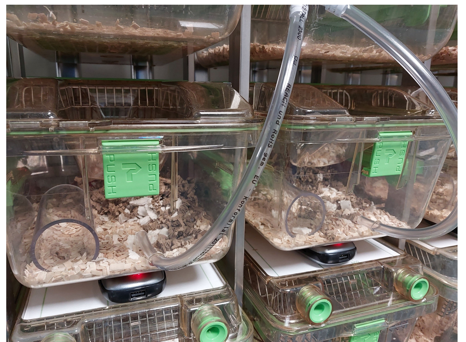
Figur 1: Opsætning af 5 IVC bure med varme og ilttilførsel. For at sikre kontakt mellem varmekude (Logilink) og IVC bur, skal buret nedenunder vendes omvendt.
